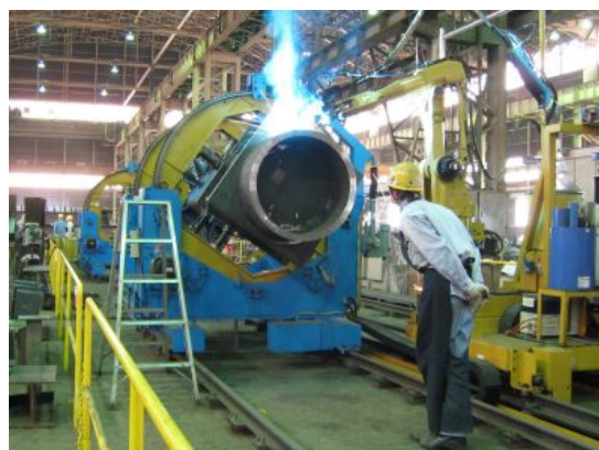
ロボット溶接の施工試験の様子
