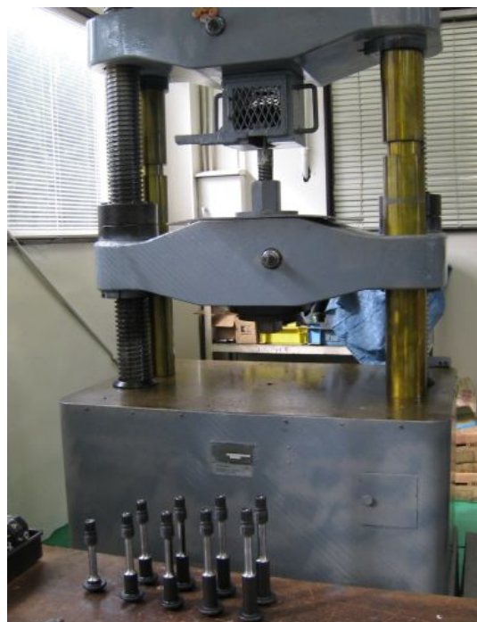
SHTB 引張試験 (手前に試験に用いた SHTB が並ぶ)
